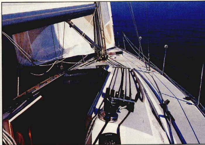
Das Deck ist rutschfest und wirkt aufgeräumt. Alle Fallen und Strecker sind nach achtern ins Cockpit umgelenkt. Gegen Aufpreis gibt es auch einen Teakbelag.
