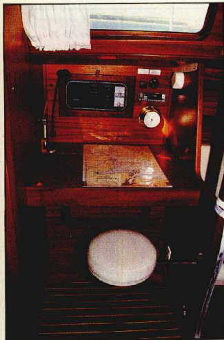
Der Kartentisch quer zur Fahrtrichtung ist bei Schräglage unpraktisch.
